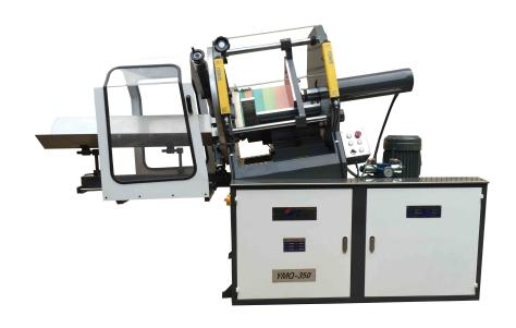
本机附带一块对刀模块,先将要切的坯料拿一张用胶水粘贴在对刀模块的下角,要求对边整齐,再将模切刀对准图案,用压板螺丝紧固拿到装料架上,本机装刀盘上有四个刀架压板,将刀架压板精确地对准刀模紧固妥当,再松开模切刀上的压板螺丝拿掉对刀模块。一切调节妥当,便可开始送料工作。建议先用点动控制,如推料及出料都顺利,便可自动控制,机器前上方手轮是微调装置,可调节纸品周边误差。
